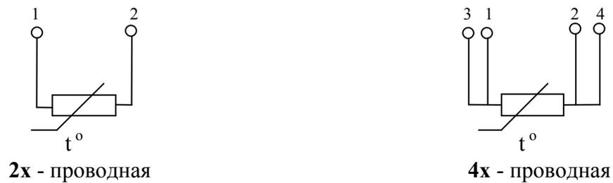
Рисунок 3. Схема соединения чувствительного элемента КТСПР 001-01,  $R=500$  Ом.
